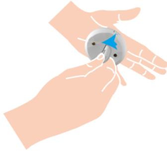
3. Halten Sie die Taste des Wassersensors 5 Sekunden lang gedrückt. Der Wassersensor wechselt in den Modus zum Hinzufügen von Geräten.
