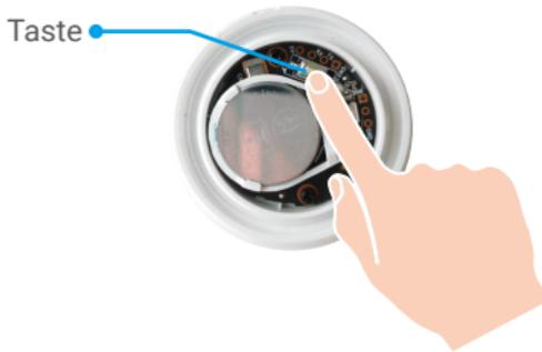
4. Wenn die Wassersensoranzeige schnell blau blinkt und dann ausgeht, wurde der Wassersensor erfolgreich zum Gateway hinzugefügt.
